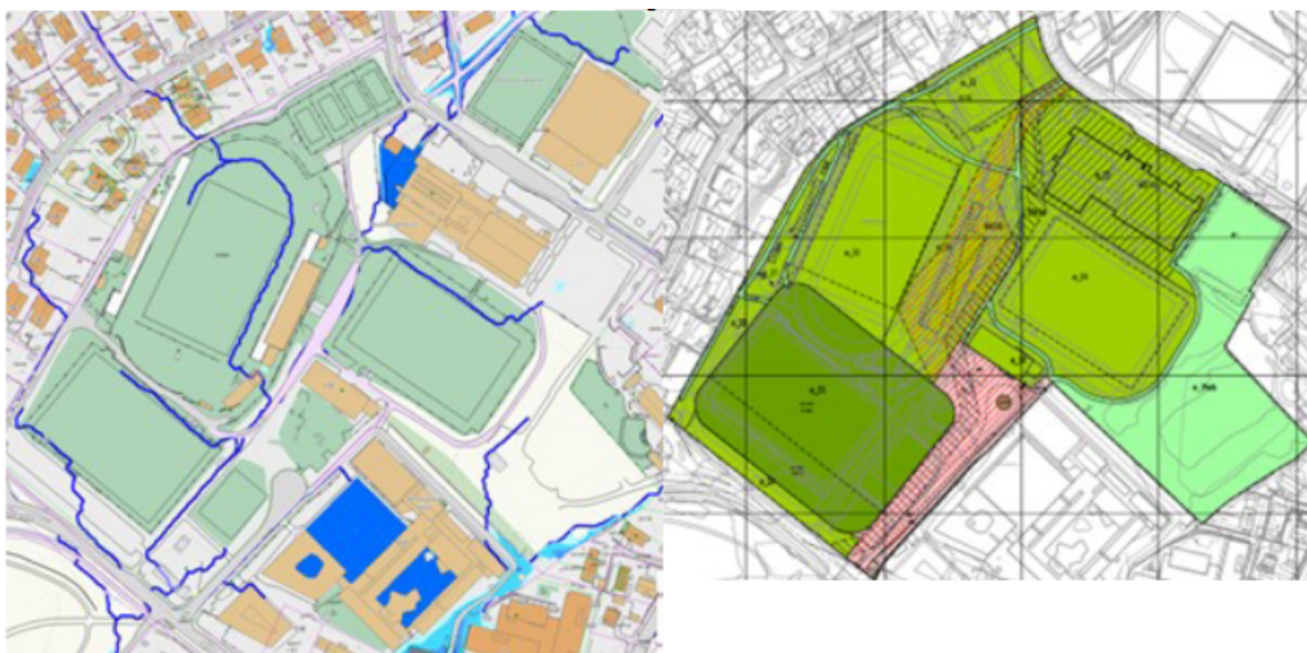
Figur 1 Kartlagte flomveier forbi prosjektområdet (venstre) og område avsatt for flomvei (rødt) i reguleringsplan (høyre).
